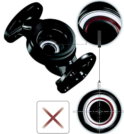
12. ábra Nem megfelelően középre igazított tömítések
